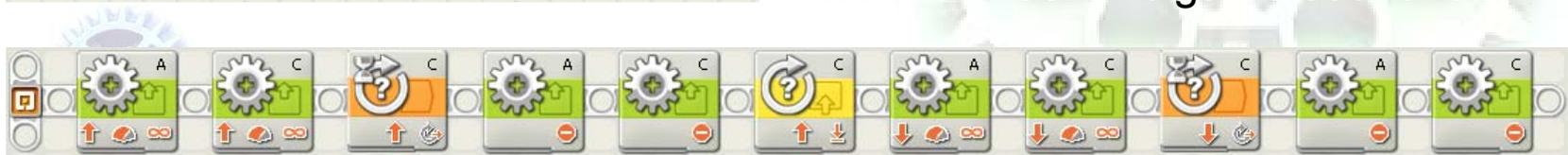
Ir adelante y volver atrás a la posición de salida, utilizando sólo motores y un sensor de rotación para controlar la distancia recorrida
